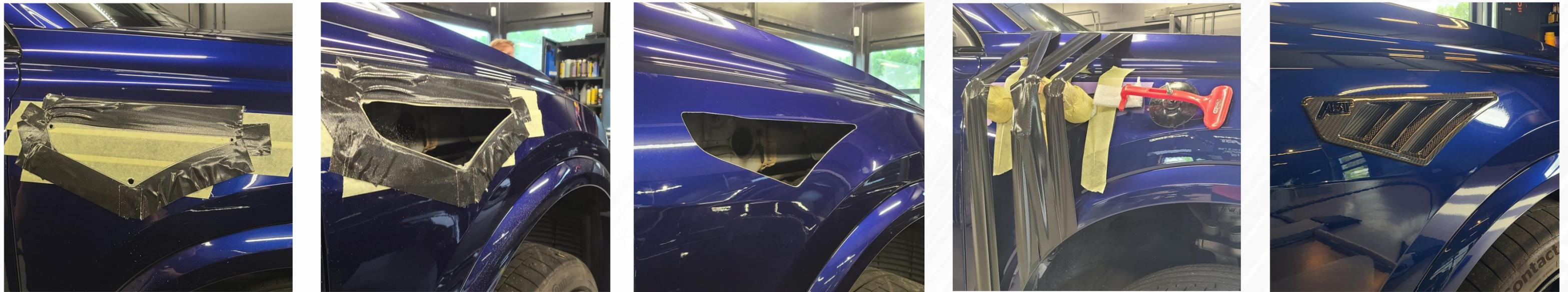
Beispiel: Montage fender inserts (Kotflügeleinsätze) an einem Audi RSQ8 inklusive Ausschnitt im Kotflügel und Einkleben des Einsatzes
